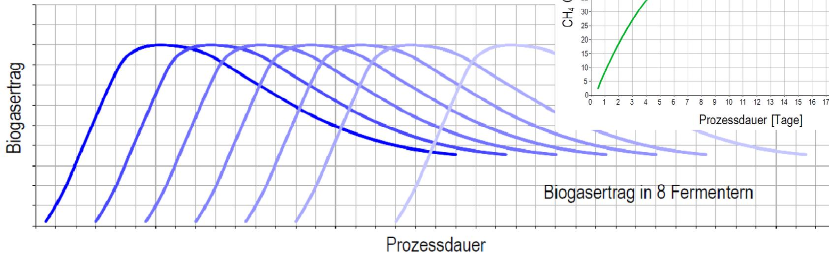
CH<sub>4</sub> Gehalt im Biogas eines Fermenters
