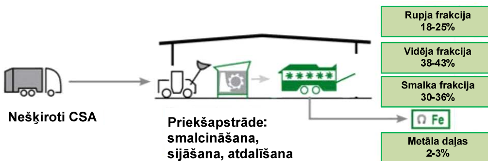
4.attēls. Mehāniskā atkritumu apstrāde Daibes poligonā (avots: Āriņa D. u.c., 2012)
